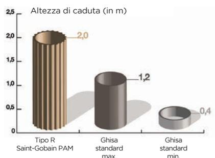
Durante il test si fa cadere una massa di 2,75 kg sui tubi incrementando l'altezza fino alla fessurazione o rottura del tubo.
